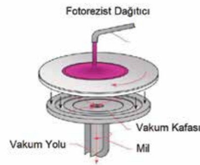
Şekil 6. Fotorezist Kaplaması
